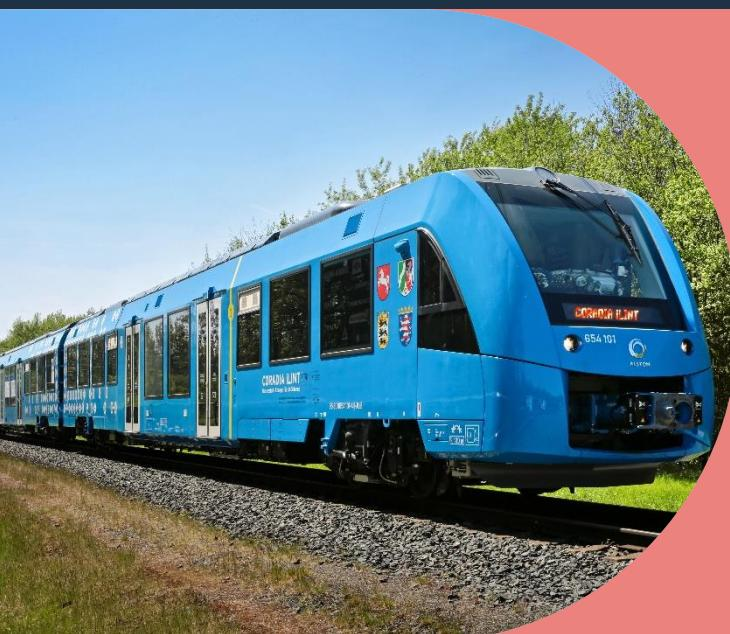
Coradia iLint ist die Lösung für emissionsfreien Schienenverkehr, basierend auf der erfolgreichen Coradia Lint Plattform von Alstom. Brennstoffzellen erzeugen Energie durch die Reaktion von Wasserstoff und Sauerstoff zu Wasser.
