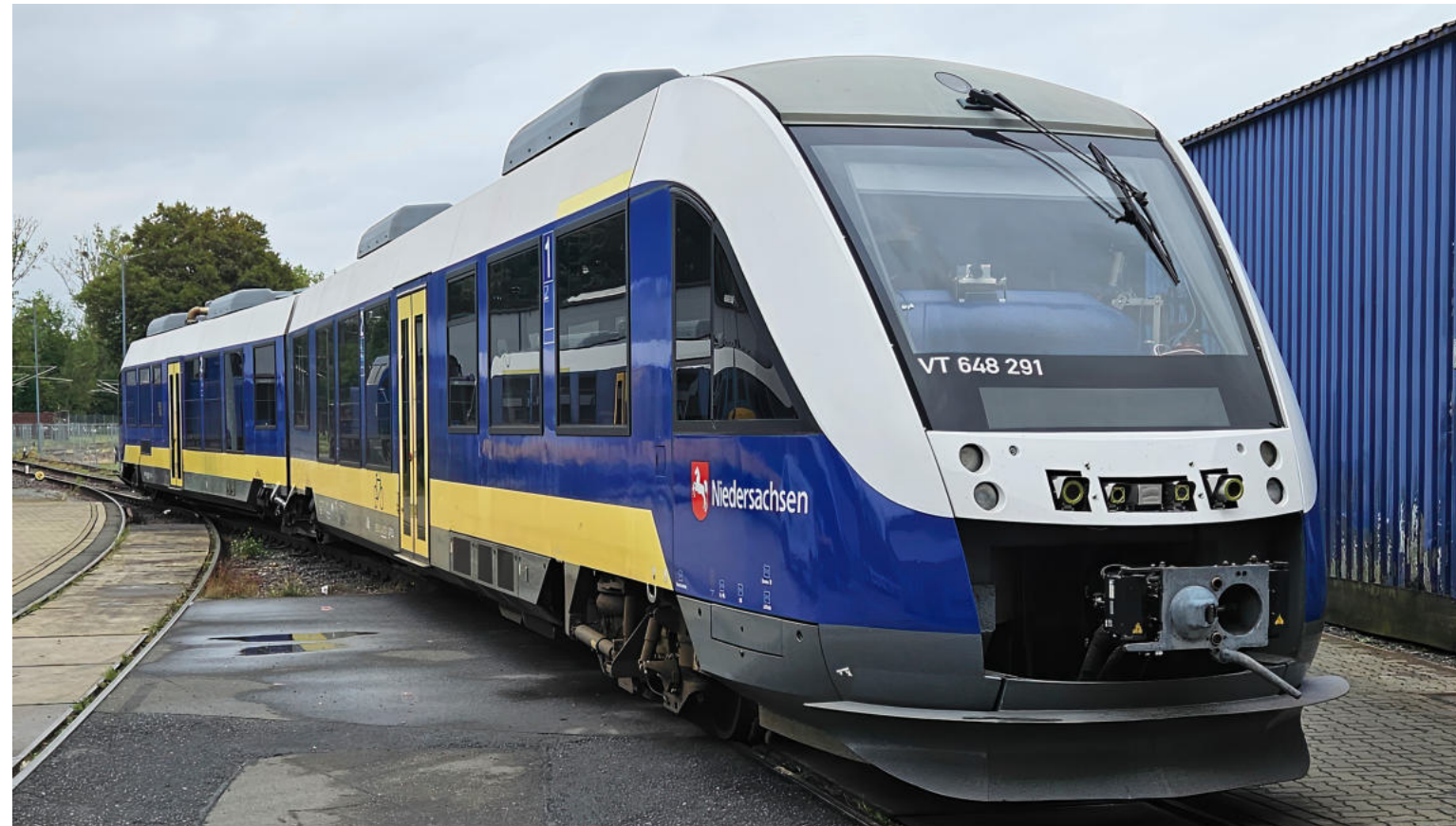
ARTE-Triebzug für automatisiertes Fahren, der Testaufbau mit der erforderlichen Sensorik ist im Frontbereich installiert
